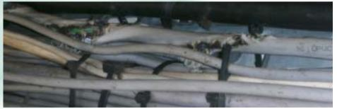
BGA Brandschäden Elektro und mehr 1,5 qmm2 – 10 / 16 A - Sicherungen
