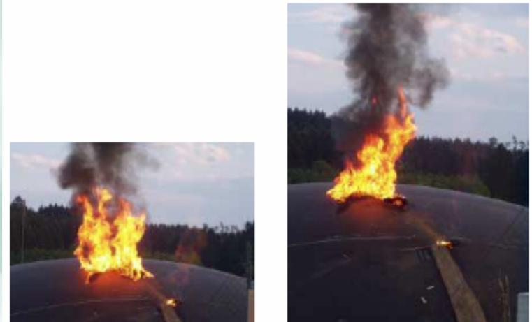
Bild 10 + 11: 6. Brandversuch ein brennender benzingertränkter Lappen wird auf den Foliengasspeicher geworfen
