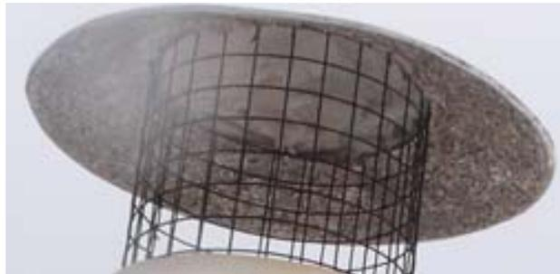
Undichter Gassack – Brand zwischen den Querlüftungen erlosch bei ca. 60 % Restfüllstand im Gassack, da nichtgenügend O<sub>2</sub> mehr vorhanden war.
